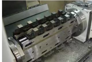
UNICLAMP Mehrfachspannstellen mit Tiefspanner auf NC-Schwenktisch
