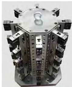
UNICLAMP Aufspannturm mit 8 Basis-Schienen 585 mm mit je vier Spannstellen
