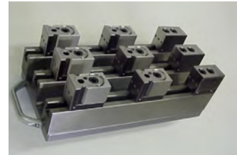
UNICLAMP Basis-Schienen 400 mm auf UNILOCK Schnittstelle bzw. Palette
